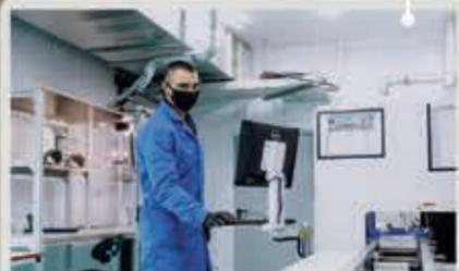
Лакировщик **Александр Зорькин** за работой на автоматической селективной установке нанесения влагозащитного покрытия на электронные платы. Площадка «КСК Элком», цех автоматизированной сборки электронных модулей.
