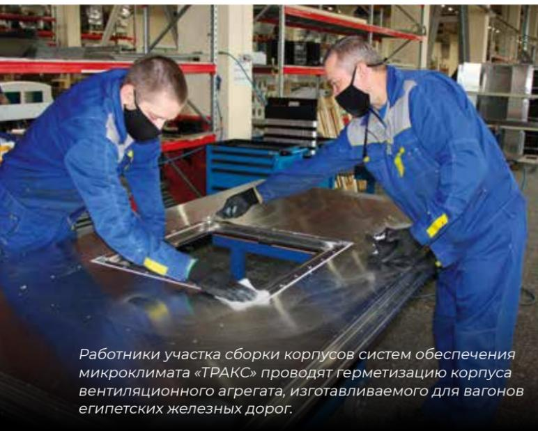
Работники участка сборки корпусов систем обеспечения микроклимата «ТРАКС» проводят герметизацию корпуса вентиляционного агрегата, изготавливаемого для вагонов египетских железных дорог.
