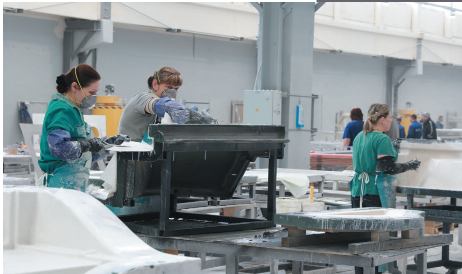
▲ При формовке деталей интерьера в цехе «НПО «Вояж» образуется большое количество отходов стеклопластика
