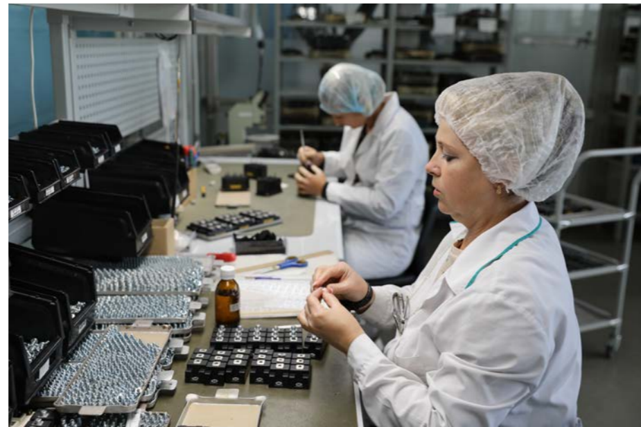
▲ Работницы цеха №15 изготавливают элементы для силовой полупроводниковой продукции
